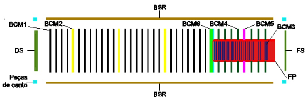
Figura 3.17: Constituição da base do contentor 40'HC.
