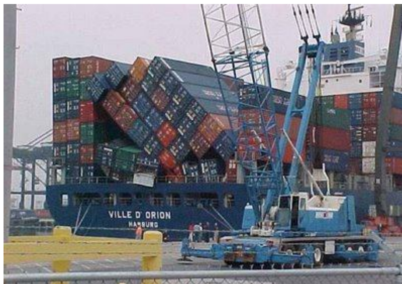
Figura 1.2: Situação de derrube em porta contentores ([14] ISBU-Intermodal Steel Building Units and Container Homes, 2009).
