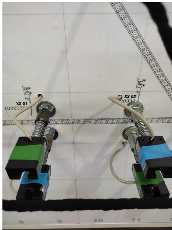
Figura 10. Poka-Yoke: desenganador para inserir abraçadeira
