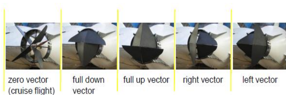
FIGURA 13: Representação do Sistema de Funcionamento da Propulsão Vectorizada em Ducto, [19]
