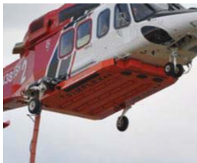
(a) Exemplo de sistema de tanque externo [25].
