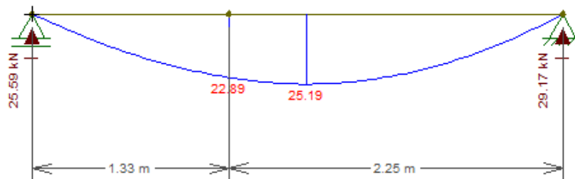
Figura 19 Diagrama de momentos fletores
