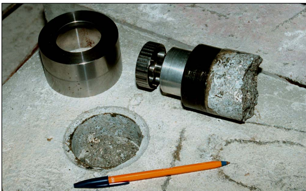
Figura 7.11 – Rotura típica de um ensaio “Pull-off” por carotagem parcial
