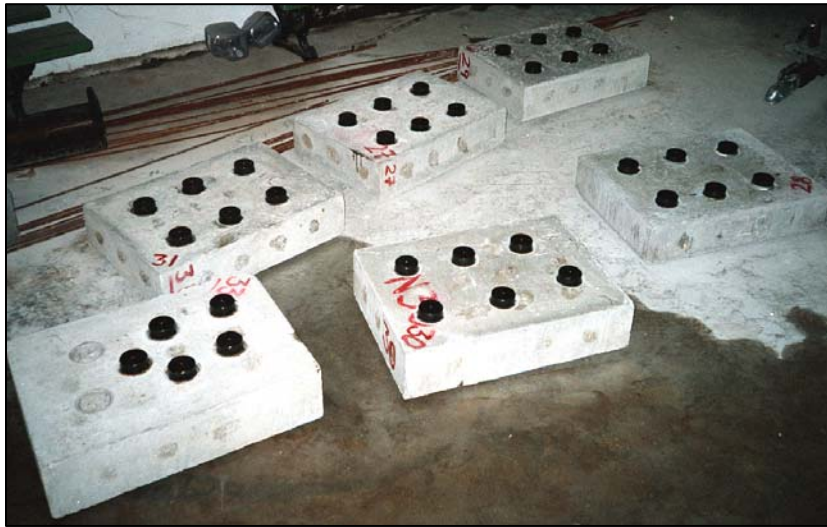
Figura 9.7 – Discos e lajes de ensaio utilizados em betões da gama de resistência normal
