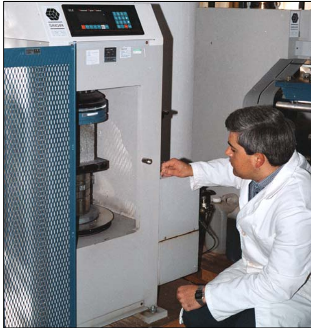
Figura 9.10 – Máquina utilizada no ensaio à compressão de provetes de betão
