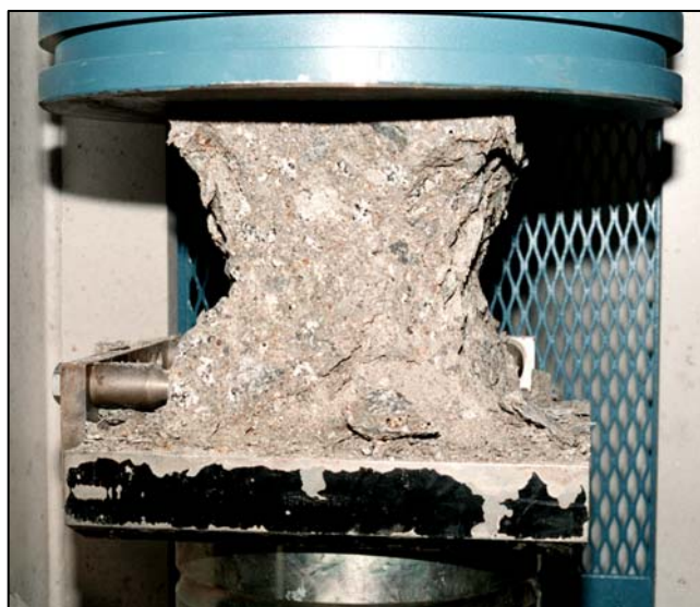
Figura 9.11 – Geometria de rotura típica observada nos ensaios de provetes cúbicos padrão
