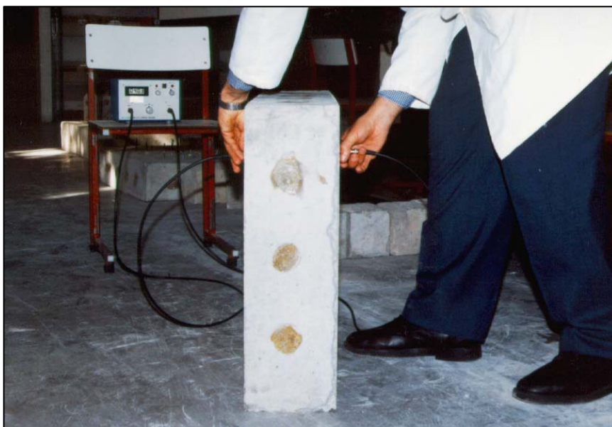
Figura 9.5 – Medição da velocidade de propagação dos ultra-sons
