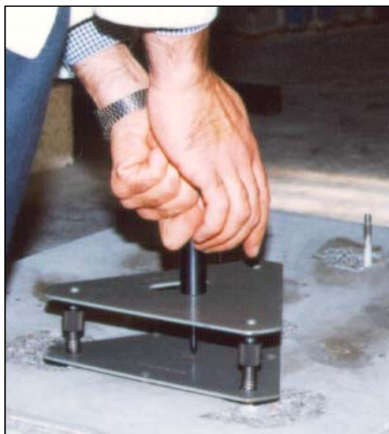
Figura 5.6 – Execução da leitura média de três ensaios com base no sistema de pratos triangulares de medição da Pistola de Windsor
