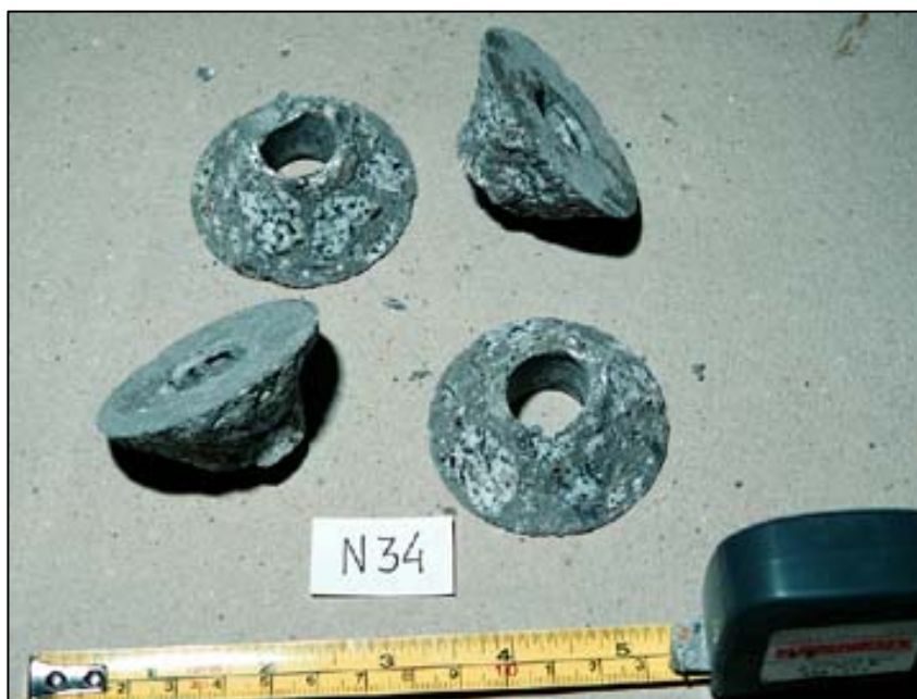
Figura 6.25 – Fragmentos tronco-cónicos extraídos no ensaio “Capo-test”
