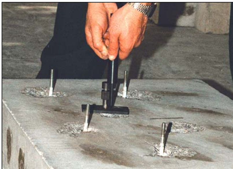
Figura 5.7 – Leitura individual da distância exposta de uma sonda no ensaio com a Pistola de Windsor
