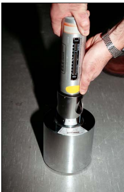
Figura 3.3 – Execução do teste de aferição de um esclerómetro do Tipo N
