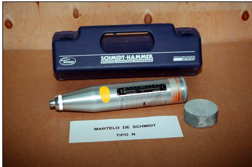
Figura 3.1 – Esclerómetro de Schmidt do Tipo N (energia de impacto = 2,207 N.m)
