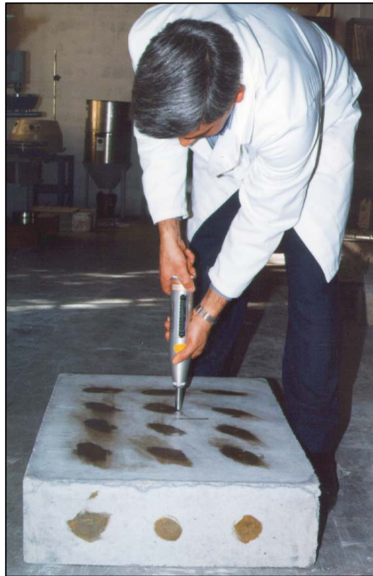
Figura 9.4 - Execução do ensaio de dureza segundo a direcção vertical
