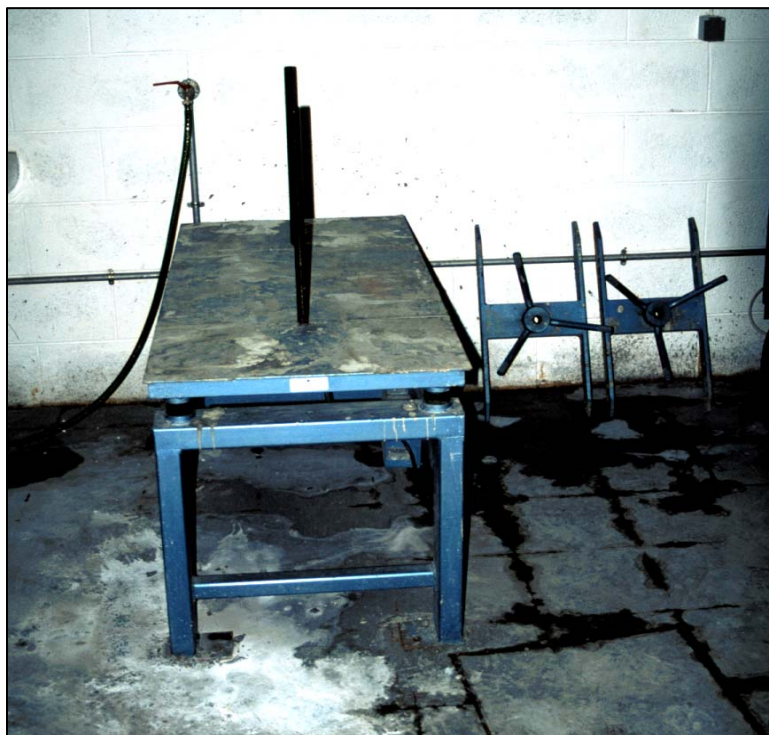
Figura 9.2 - Mesa vibratória utilizada para compactar o betão dos provetes padrão e das lajes de ensaio.
