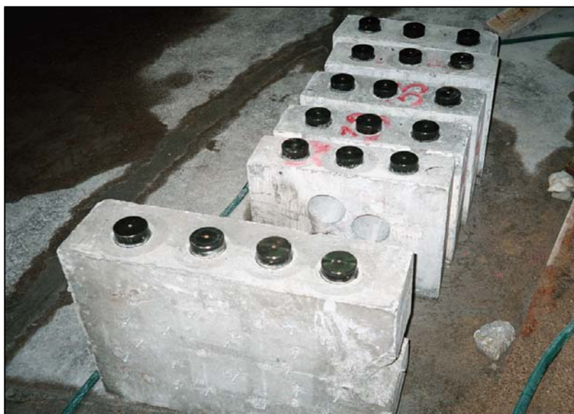
Figura 9.9 – Discos e lajes de ensaio utilizados em betões da gama de alta resistência
