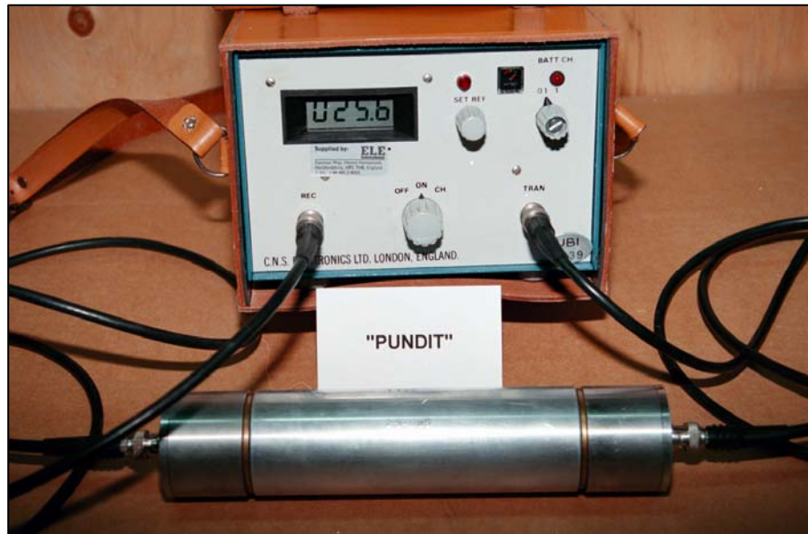
Figura 4.3 – Operação de aferição do aparelho de medição da velocidade de propagação dos ultra-sons
