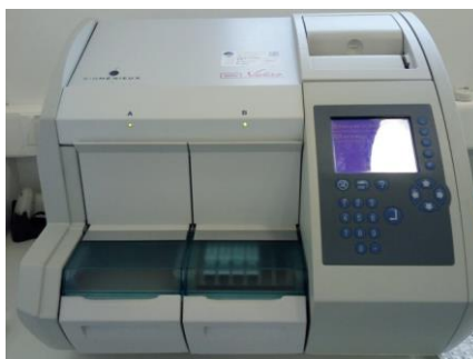
Figura 7 – Utilização do aparelho Mini-Vidas na deteção de amostras de Salmonella spp.
