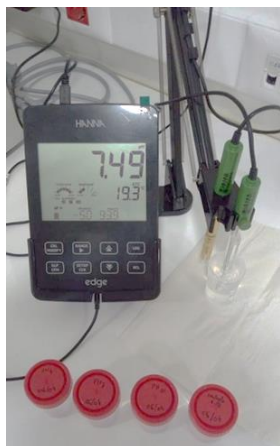
Figura 40 – Medição do valor de pH de uma amostra de água.
