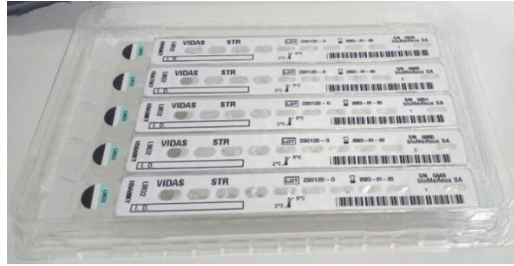
Figura 10 – Barretes pertencentes ao kit específico para detecção de Listeria monocytogenes .
