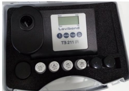
Figura 42 – Turbidímetro com os 4 padrões de calibração.
