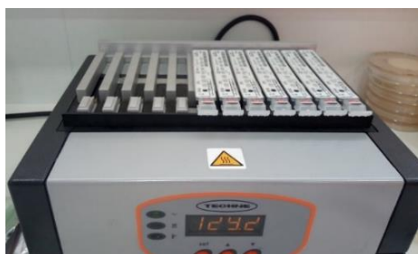
Figura 6 – Processo de aquecimento das barretes, no bloco de aquecimento VIDAS Heat & Go .
