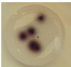
Figura 30 – Membrana em BEA, pós-incubação, com 4 colónias confirmadas de Enterococcus .
