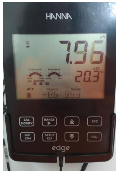
Figura 39 – Leitura do valor de pH de uma amostra. Visualização do valor do declive e de offset , obtidos após a calibração.
