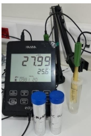
Figura 41 – Leitura da condutividade de uma amostra de água.
