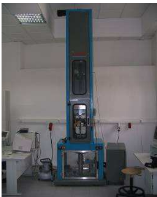
Figura 3.3 - Máquina de impacto IMATEK-IM10: a) Vista geral; b) Vista de detalhe.
