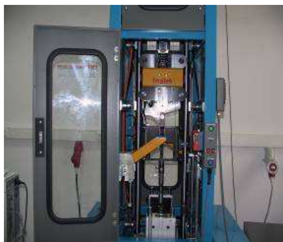
Figura 3.3 - Máquina de impacto IMATEK-IM10: a) Vista geral; b) Vista de detalhe.
