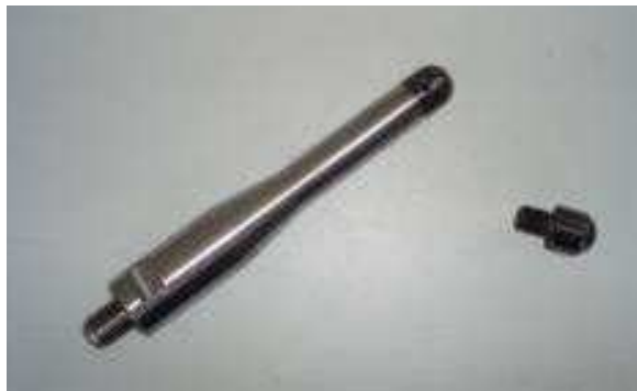
Figura 3.4 - Impactor hemisférico de diâmetro 20 mm utilizado nos ensaios de impacto.
