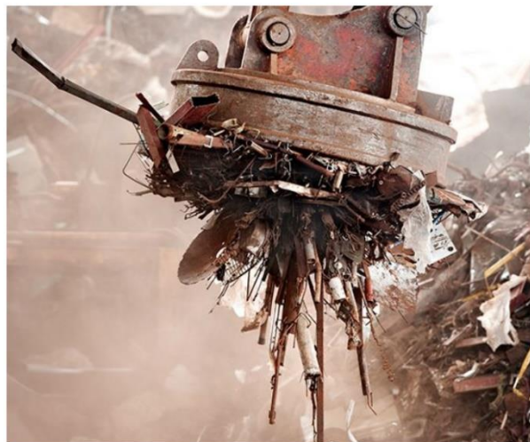
Figura 18 - Extração de metais ferrosos com íman (Bureau of International Recycling, s.d.)
