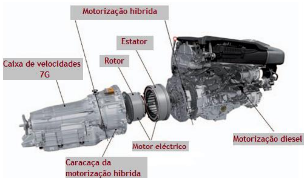
Figura 3 - Montagens de um motor eléctrico com um motor de combustão interna. Adaptado de [7].
