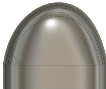
Figura 33 - Biqueira com espessura variável visível da biqueira.
