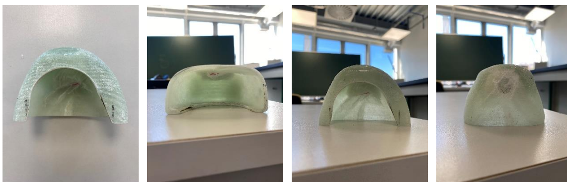
Figura 64 - Biqueira aditivada após o teste de impacto.
