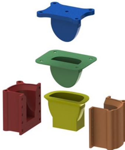
Figura 43 - Representação do molde da biqueira impresso na impressora 3D.
