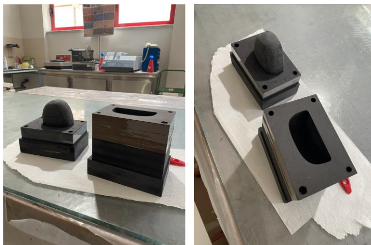
Figura 39 - Molde do Macho e da Fêmea da Biqueira em MDF hidrófugo.
