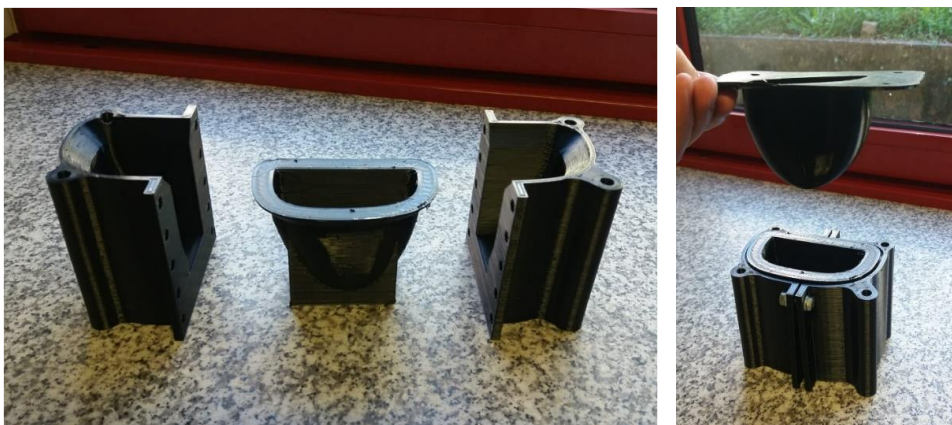
Figura 46 - Molde da biqueira após impressão.
