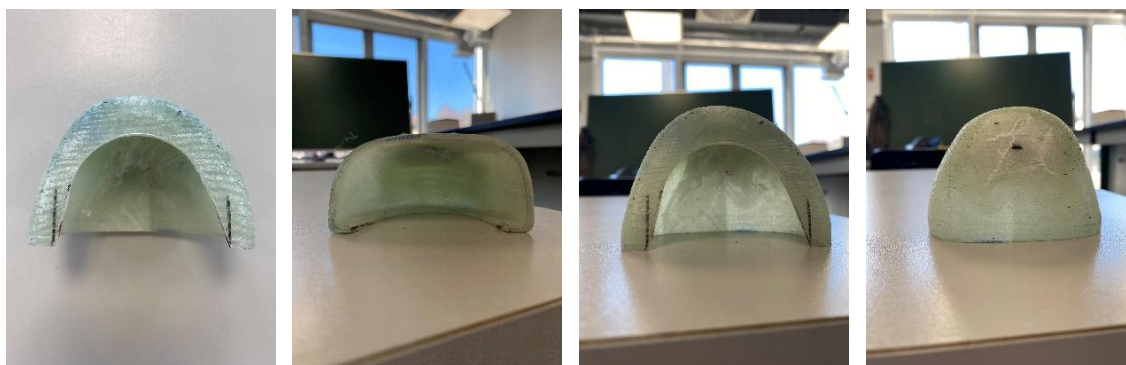
Figura 63 - Biqueira de controlo após o teste de impacto.
