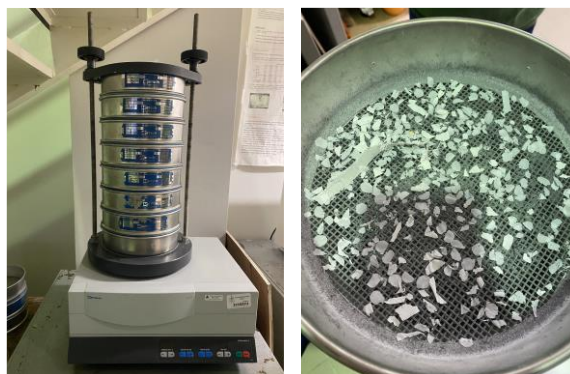
Figura 18 - Análise Granulométrica por Peneiração a Seco: Equipamento; Partículas peneiradas com tamanho 2,36 mm.
