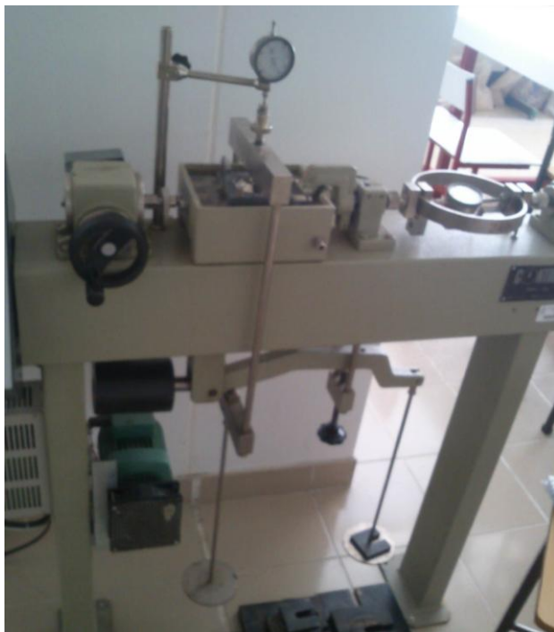
Figura 2.5 - Máquina de Corte Direto do Laboratório de Mecânica dos Solos do DECA da UBI.
