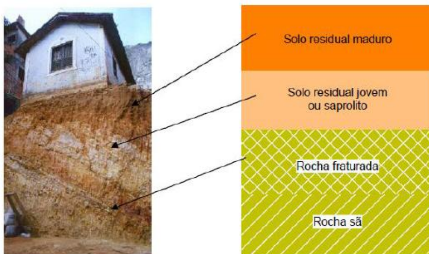
Figura 1.27 - Perfil geotécnico típico de solo residual (Ortigão, 2007).
