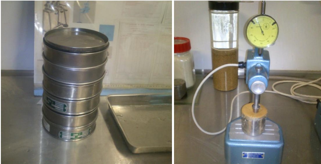
Figura 2.4 - Fotografias sobre os principais ensaios de identificação efetuados no presente estudo: análise granulométrica e limite de Liquidez pelo método do cone.
