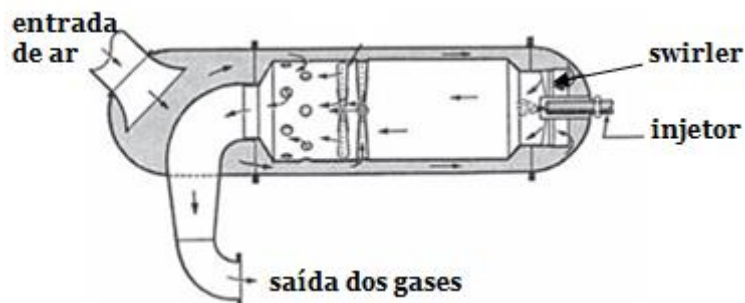
Figura 4 - Atomizador do fluxo reverso (adaptado de [1]).
