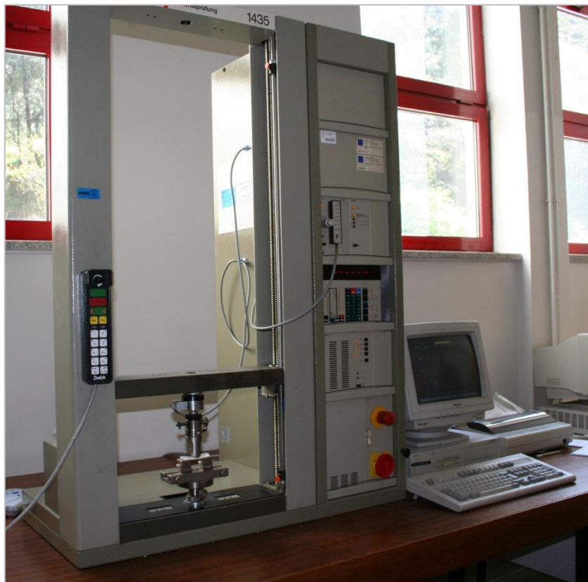
Figura 2.6 - Máquina Zwick modelo 1435, utilizada nos ensaios de flexão
