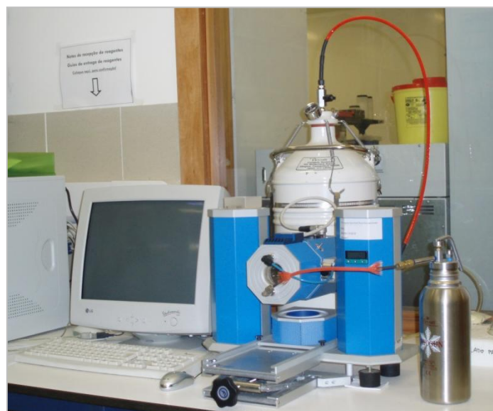
Figura 2.9 - Equipamento DMTA da marca Triton Technology, modelo Tritec 2000
