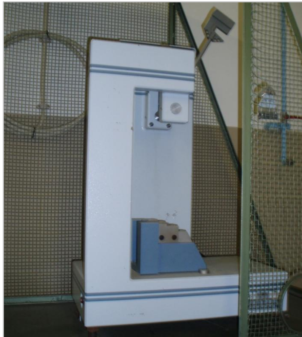
Figura 2.7 - Máquina Ceast modelo 6545 utilizada nos ensaios Charpy
