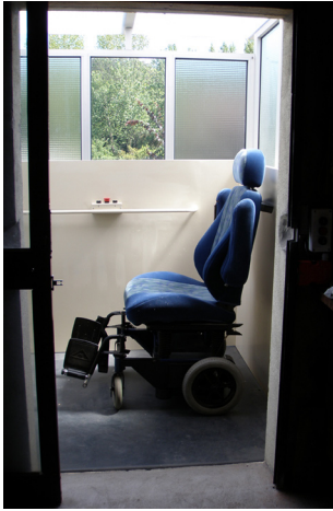
Figura AV.5 Cadeira de rodas feita a partir do assento do automóvel.
