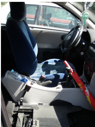
Figura AV.6 Adaptação ao automóvel para receber o assento.
