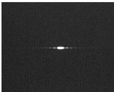
Figura 5-11 Padrão de difracção de Fraunhofer de uma fenda simples de 50 \mu\text{m} de largura.
