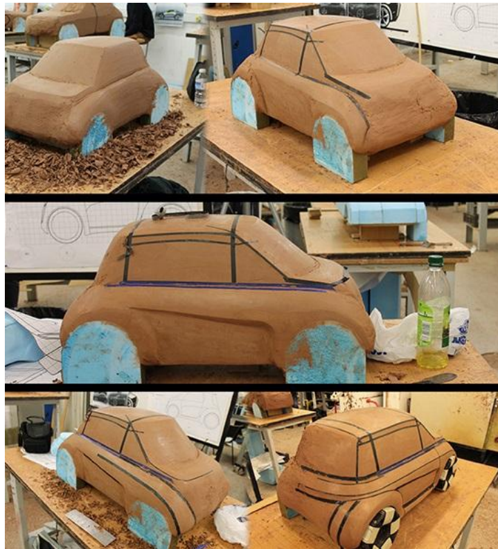
Figura 30- Modelo de automóvel em semelhança geométrica
