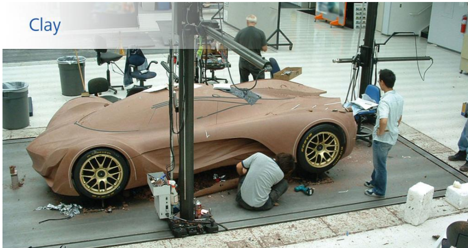
Figura 31- Modelação numérica e manual de modelo em barro de modelação (clay past)
