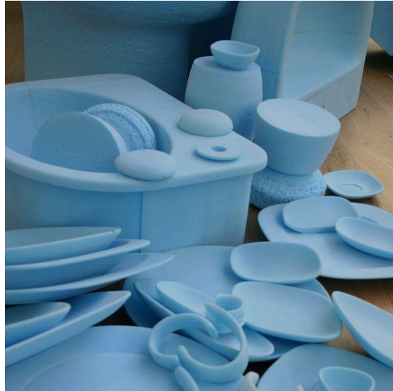
Figura 43- Modelos de desenvolvimento em poliestireno extrudido
