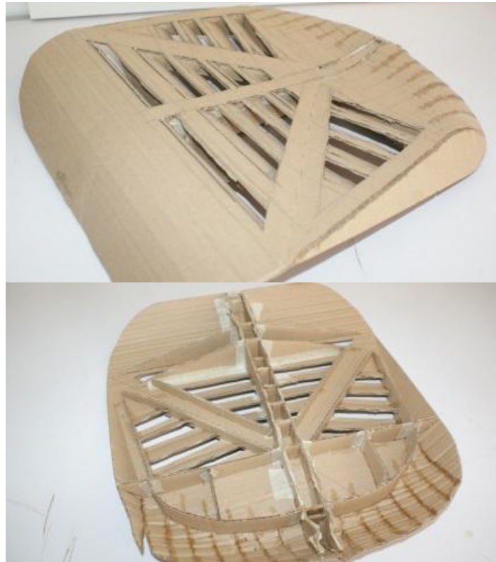
Figura 40- Modelo material tridimensional à semelhança geométrica e produtiva para base de assento a produzir em fundição de metal por molde de areia
