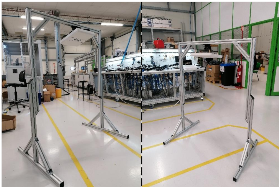
Fig. 13. Estrutura de pórtico de leitura RFID com a montagem do leitor e da antena.
