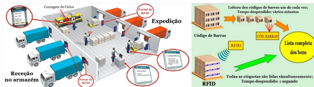
Fig. 8. Implementação de RFID em armazém (Adaptado de Popova et al. , 2021).
