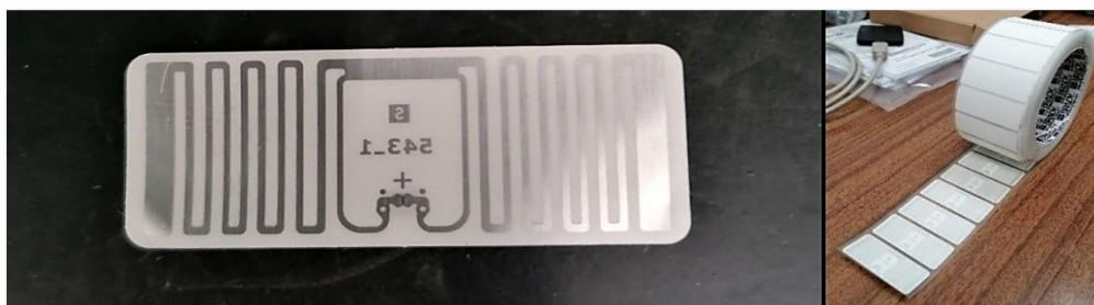
Fig. 14. Tipo de etiquetas de RFID usadas para o sistema de rastreabilidade.
