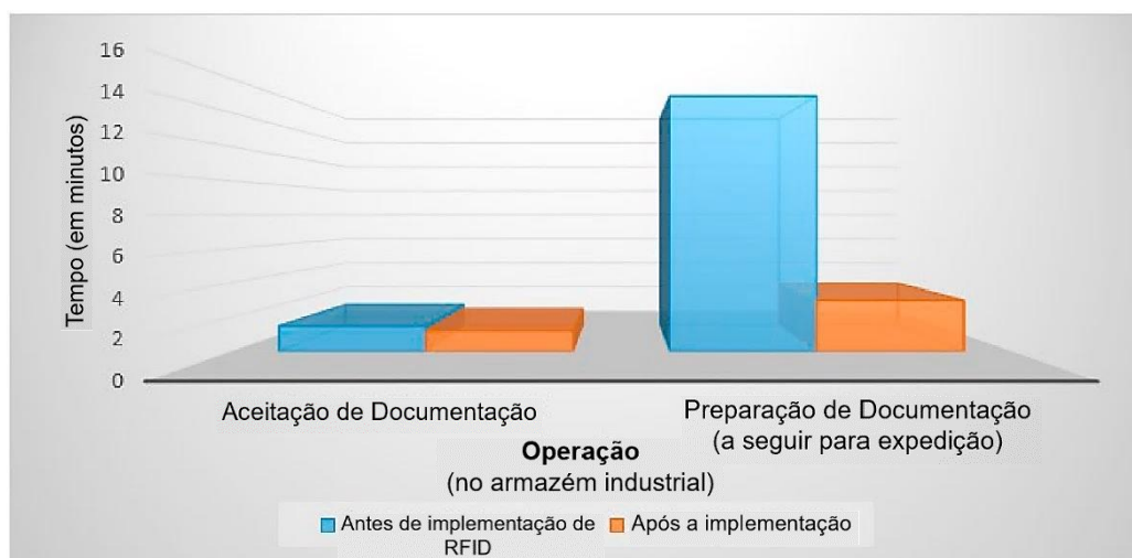
Fig. 9. Demonstração da otimização de uma operação de logística através da integração de RFID (Adaptado de Popova et al. , 2021).
