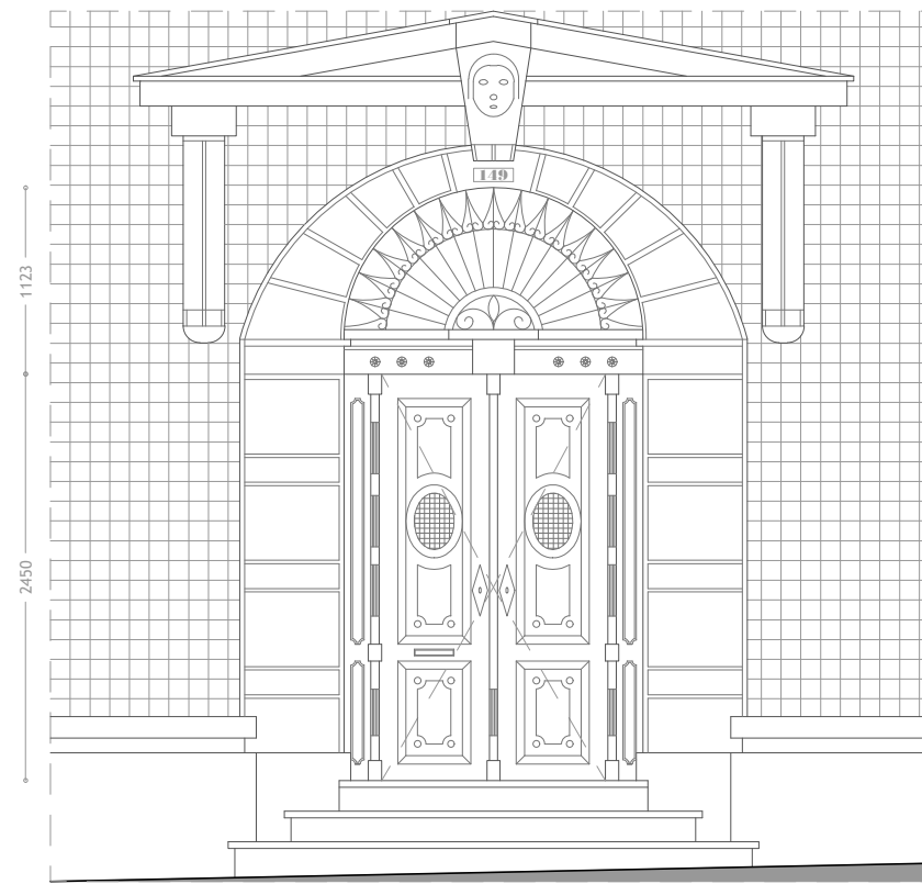
Imagem 150- Levantamento gráfico da Porta P1 - Exterior - Escala 1:50
