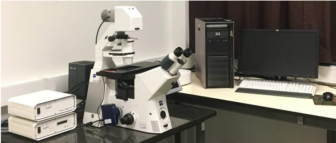
Figura 7. Microscópio de fluorescência invertido - Zeiss Axio Observer Z1 - com incorporação de câmara digital monocromática de alta velocidade - Axio Cam Hsm - e com uma placa de aquecimento.
