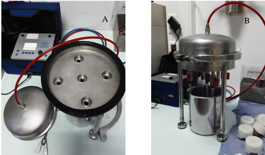
Figura 12: Medidor de integridade de filtros. A) Medidor aberto, é demonstrado as ranhuras onde se colocam os filtros para serem analisados; B) Medidor fechado com o teste a decorrer
