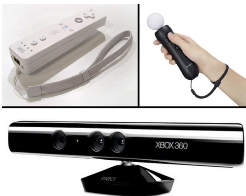
Figura 2.6: Novos controladores de movimento: Wii Remote (cima à esquerda), Move (cima à direita) e Kinect (baixo)
