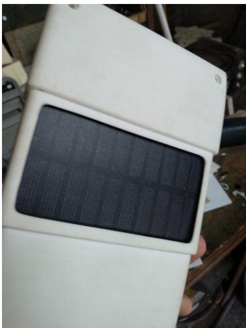
Figura 65 – Painel solar embutido na tampa de trás, Dário Agapito, 2020
