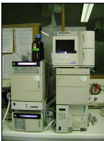
Figura 3.2. Equipamento de HPLC ( Lachrom, Merck Hitashi ) com detector DAD ( Hitachi, modelo L-7455 ) utilizado.
