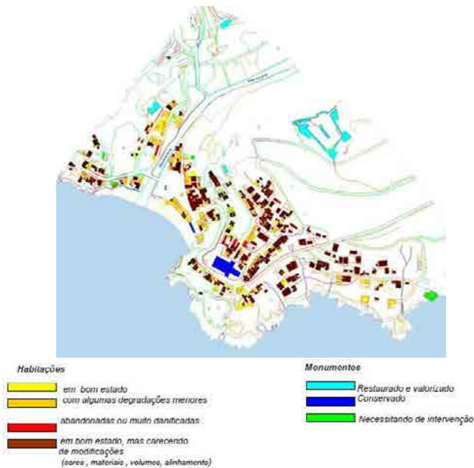
Figura 40 - Estado de conservação dos edifícios. (Fonte: (CARVALHO & AKIBODÉ, 2008))
