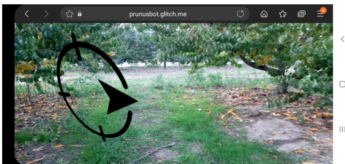
Fig. 54. Resultado da página web com o incremento da realidade aumentada com 10 m de distância entre os waypoints : Virar à direita.
