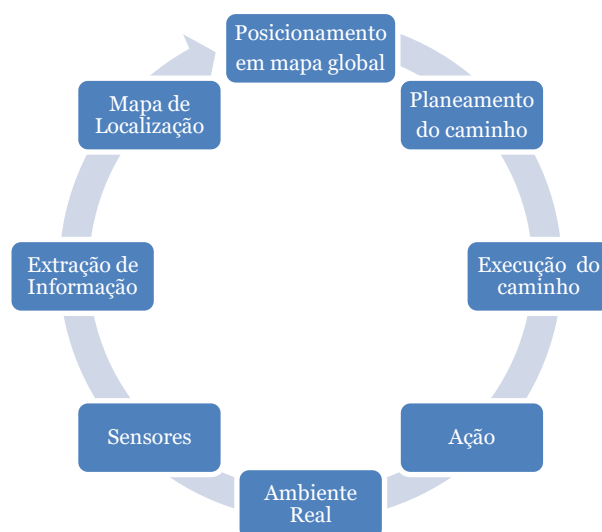
Fig. 12. Esquema de um controlador inteligente (Singh, et al., 2008) - Adaptado
