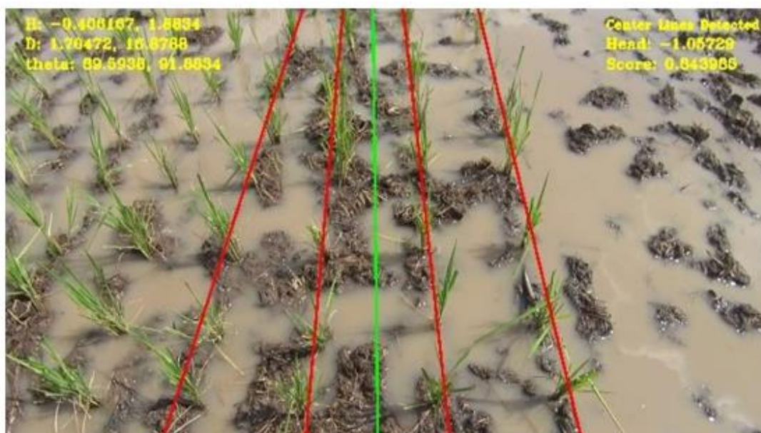
Fig. 6. Resultado da navegação baseada em visão computacional mostrando as linhas de cultivo (Kanagasingham, et al., 2019).
