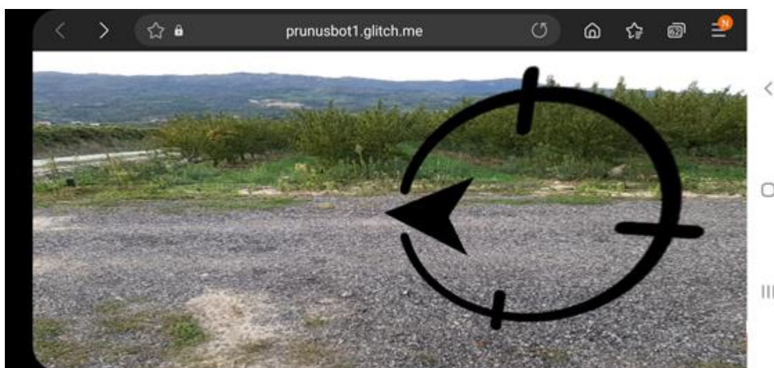
Fig. 55. Resultado da página web com o incremento da realidade aumentada com 5 m de distância entre os waypoints : virar à esquerda.
