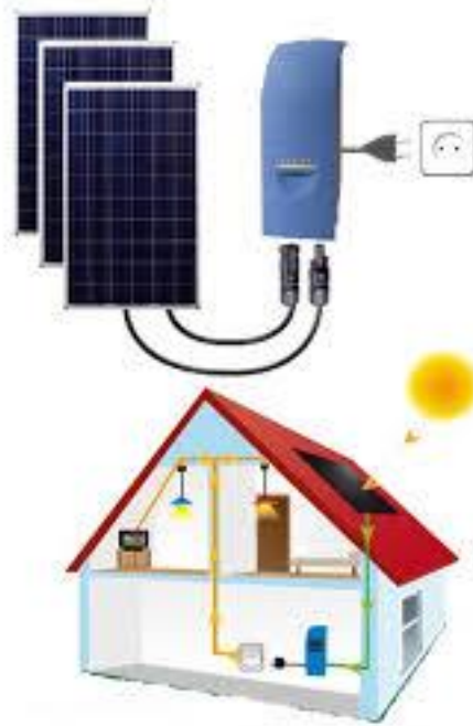
Figura 4.1 - Esquema simplificado de uma unidade de produção para autoconsumo [51].
