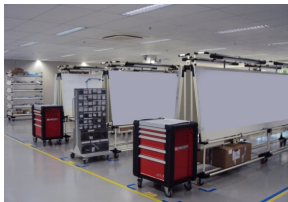
Figura 22 - Painel de montagem de cabos. Fonte -
