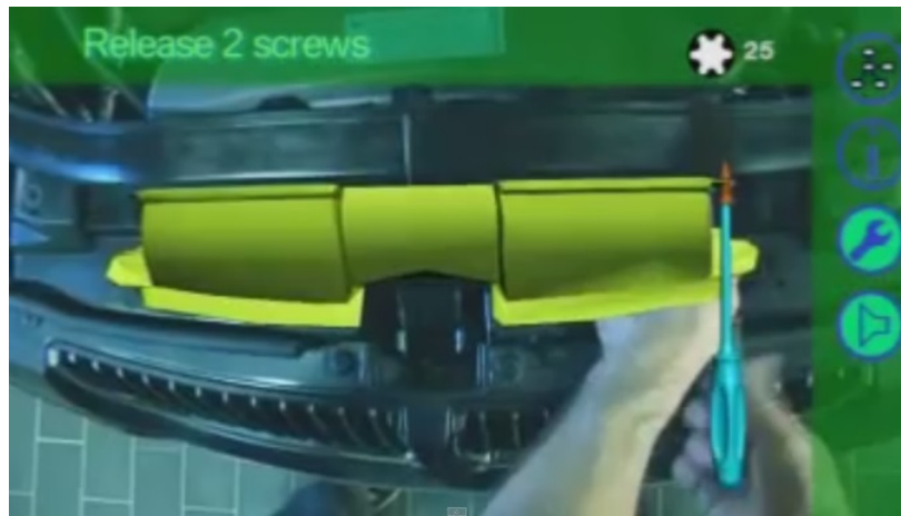
Figura 19 - Imagem de realidade aumentada onde se explica que deve-se desapertar 2 parafusos. Imagem editada. Fonte https://www.youtube.com/watch?v=xrWwSXgF4Lc , acessido em 19 de setembro de 2014
