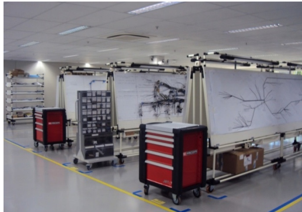
Figura 21 - Painel de montagem de cabos. Fonte -
