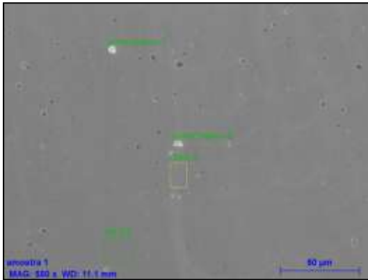
Figura 3.12- Impurezas encontradas na peça Mousqueton, a uma ampliação de 1000x.
