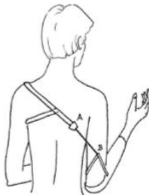
Figura 46: Acionamento da prótese ativada corporalmente (Groenewegen, 2014).
