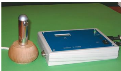
Figura 49: Sensores de força e unidade eletrónica Bretz et al. (2010).
