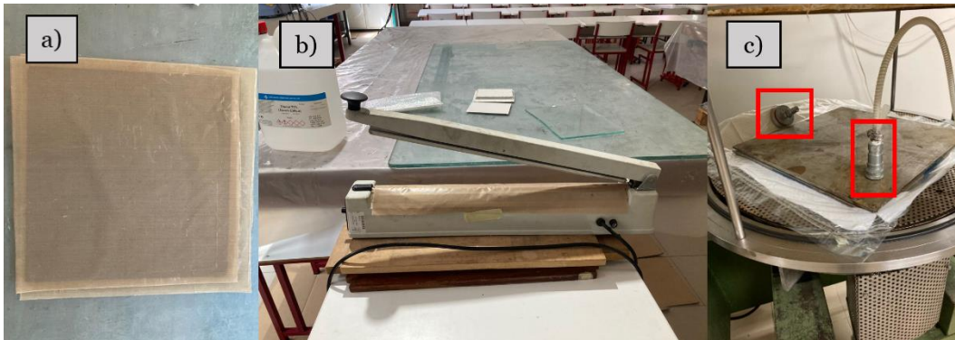
Figura 30: a) placas resultantes antes do processo de cura, b) equipamento utilizado para selar o saco com a placa e c) interior da autoclave onde é visível a aplicação do peso e válvula de vácuo.
