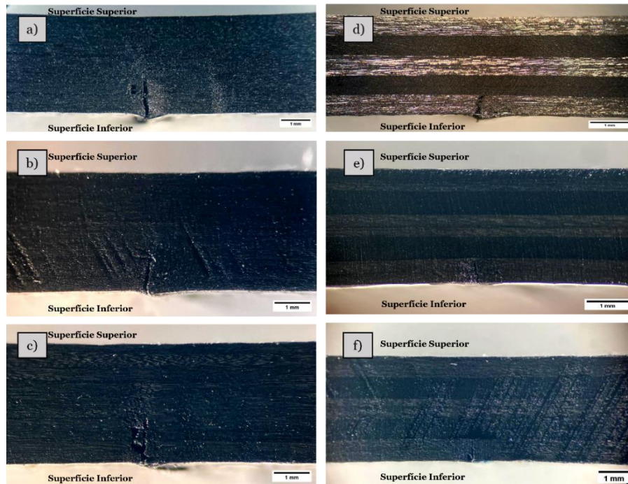
Figura 54: Amostras sem defeito. a) amostra 1 construção unidirecional, b) amostra 2 construção unidirecional, c) amostra 3 construção unidirecional, d) amostra 1 construção cruzada, e) amostra 2 construção cruzada e f) amostra 3 construção cruzada.
