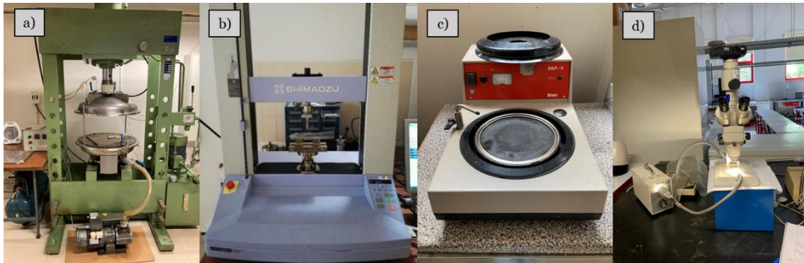
Figura 27: Equipamento laboratorial utilizado. a) autoclave, b) máquina de teste universal, c) máquina para polimento, d) luz e lupa.
