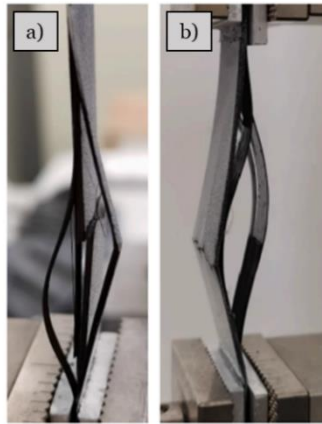
Figura 14: Falha mecânica nas amostras em teste de encurvadura. a) amostra B, defeito no plano do meio e b) amostra D, defeito na face superior [18].
