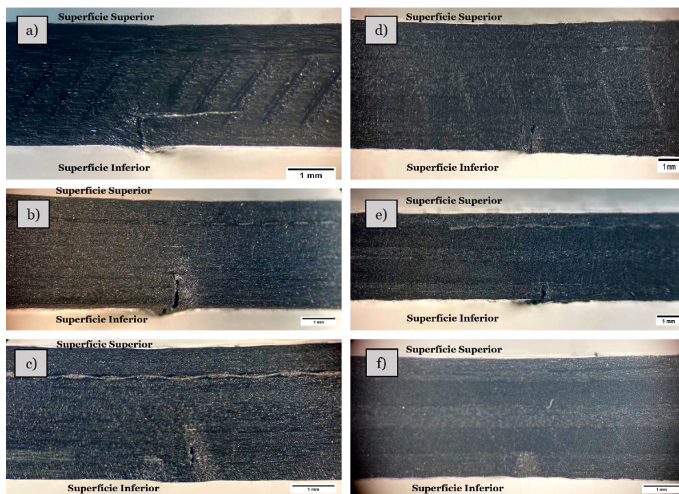
Figura 58: Amostras com defeito de 5 mm à compressão. a) amostra 4 construção unidirecional, b) amostra 5 construção unidirecional, c) amostra 6 construção unidirecional, d) amostra 4 construção cruzada, e) amostra 5 construção cruzada e f) amostra 6 construção cruzada.
