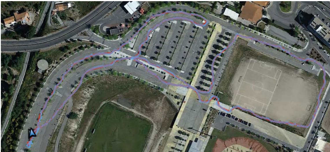
Figura 5.4: Imagem dos trajectos recolhidos pelo Wiko Wax. A azul o trajecto original e a vermelho o trajecto resultante da análise do algoritmo.
