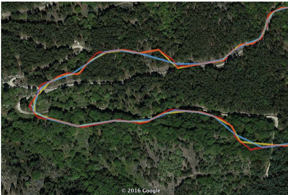
Figura A.6: Comparaçãõ entre três percursos. Imagem que mostra parte do percurso realizado no Circuito de Manutenção da Covilhã. A azul o trajecto original recolhido pelo smartphone Wiko Wax, a vermelho o trajecto resultante do algoritmo elaborado e a amarelo o trajecto obtido pelo GPS Visualizer.
