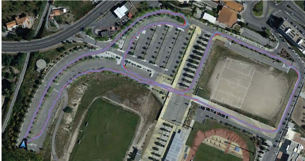
Figura 5.8: Imagem dos trajectos recolhidos pelo Sony Xperia. A azul o trajecto original e a vermelho o trajecto resultante da análise do algoritmo.
