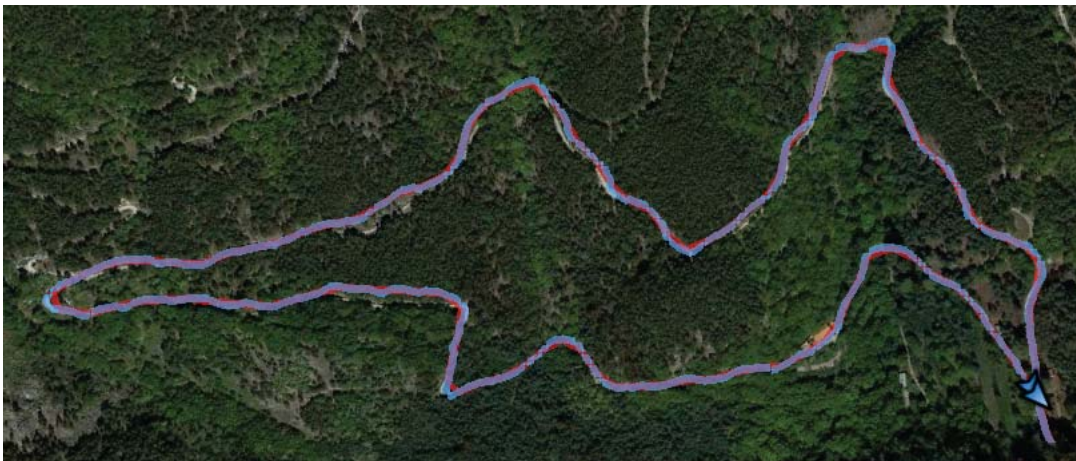
Figura B.53: Imagem dos trajectos recolhidos pelo Nexus 5 no Circuito de Manutenção. A azul o trajecto original e a vermelho o trajecto resultante da análise do algoritmo.
