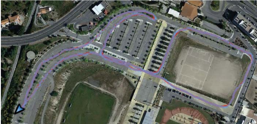
Figura B.18: Imagem dos trajectos recolhidos pelo Umi Hammer. A azul o trajecto original e a vermelho o trajecto resultante da análise do algoritmo.
