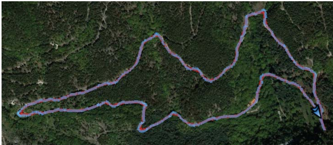
Figura B.23: Imagem dos trajectos recolhidos pelo Samsung Galaxy S5 no Circuito de Manutenção. A azul o trajecto original e a vermelho o trajecto resultante da análise do algoritmo.
