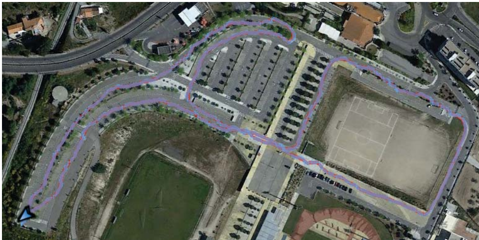
Figura B.28: Imagem dos trajectos recolhidos pelo Samsung Galaxy S5. A azul o trajecto original e a vermelho o trajecto resultante da análise do algoritmo.
