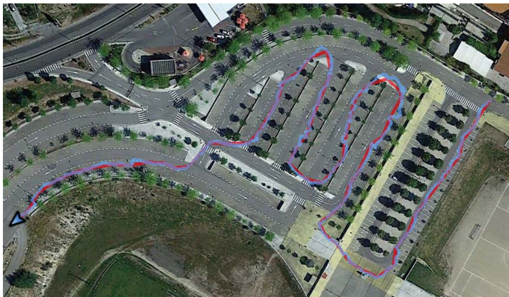
Figura A.13: Imagem da sobreposição do trajecto original e do trajecto resultante da análise do algoritmo desenvolvido.
