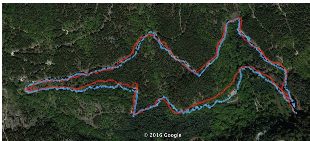
Figura 3.3: Imagem que mostra os trajectos guardados pelo LG G3 (a azul) com apenas o GPS ligado e o trajecto do UMI Hammer (a vermelho) com o GPS ligado e conectado a uma Internet móvel.
