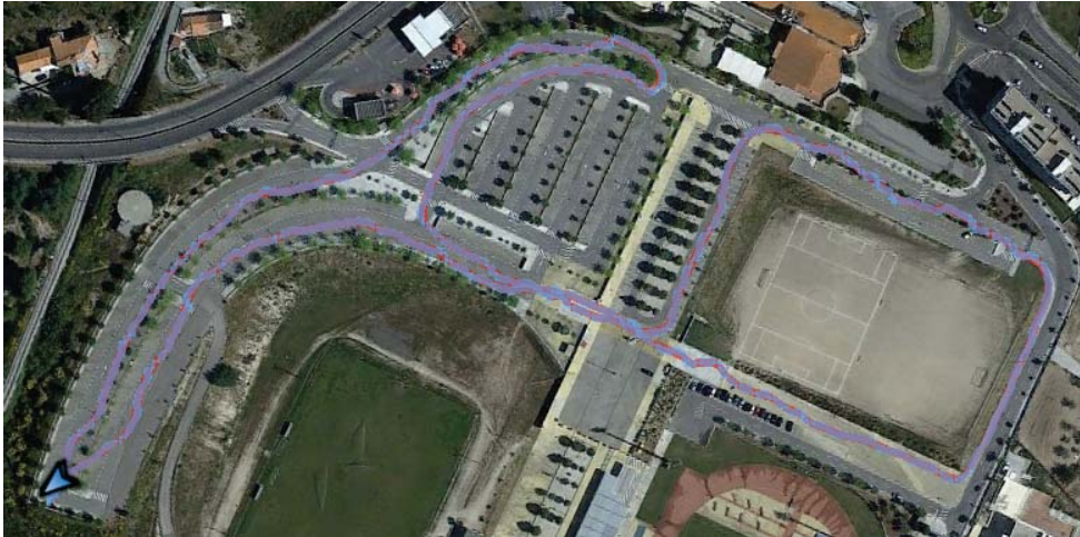
Figura B.38: Imagem dos trajectos recolhidos pelo Samsung Galaxy S5. A azul o trajecto original e a vermelho o trajecto resultante da análise do algoritmo.
