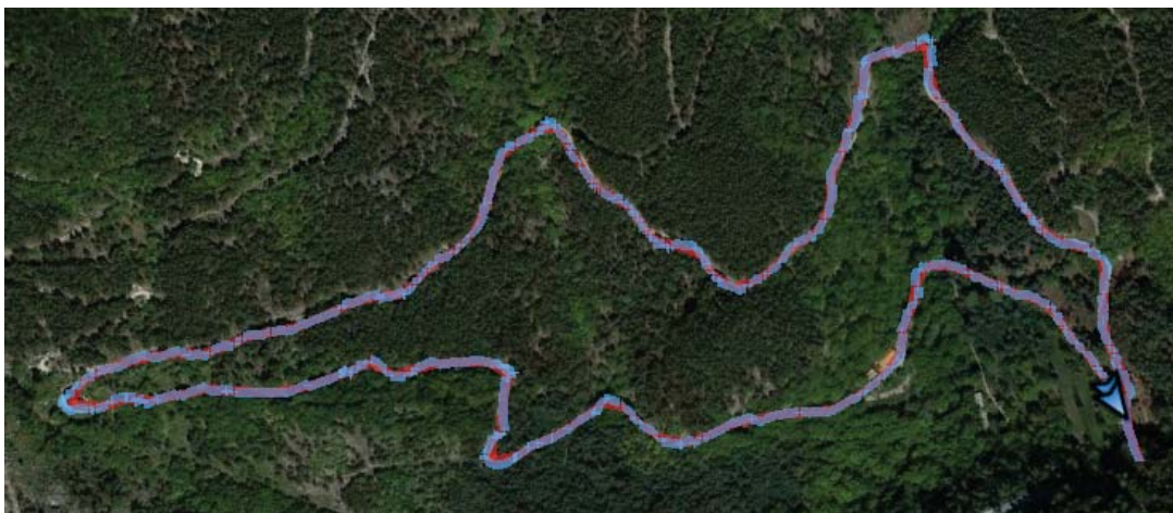
Figura B.33: Imagem dos trajectos recolhidos pelo Samsung Galaxy S5 no Circuito de Manutenção. A azul o trajecto original e a vermelho o trajecto resultante da análise do algoritmo.
