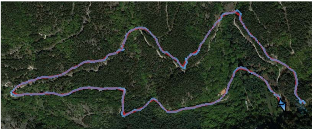
Figura B.43: Imagem dos trajectos recolhidos pelo Alcatel Idol 3 no Circuito de Manutenção. A azul o trajecto original e a vermelho o trajecto resultante da análise do algoritmo.
