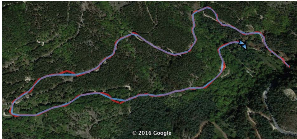
Figura A.5: Imagem total do trajecto realizado. A azul o trajecto original e a vermelho o trajecto resultante da análise do algoritmo desenvolvido.
