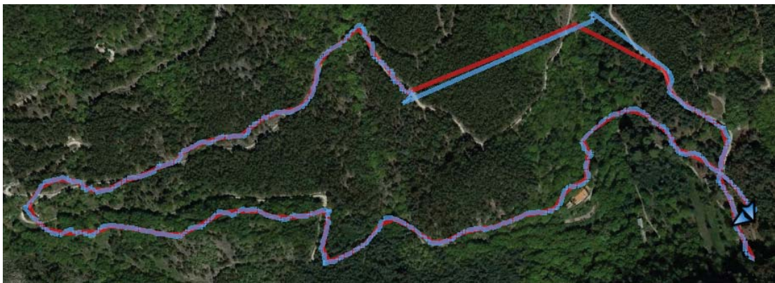
Figura B.73: Imagem dos trajectos recolhidos pelo Umi Hammer no Circuito de Manutenção. A azul o trajecto original e a vermelho o trajecto resultante da análise do algoritmo.
