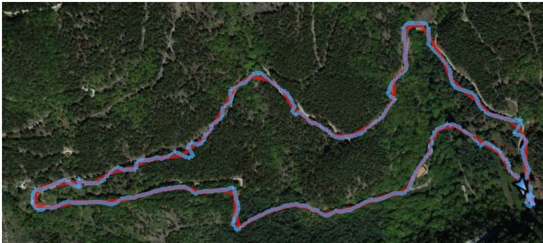
Figura B.3: Imagem dos trajectos recolhidos pelo LG G2 no Circuito de Manutenção. A azul o trajecto original e a vermelho o trajecto resultante da análise do algoritmo.
