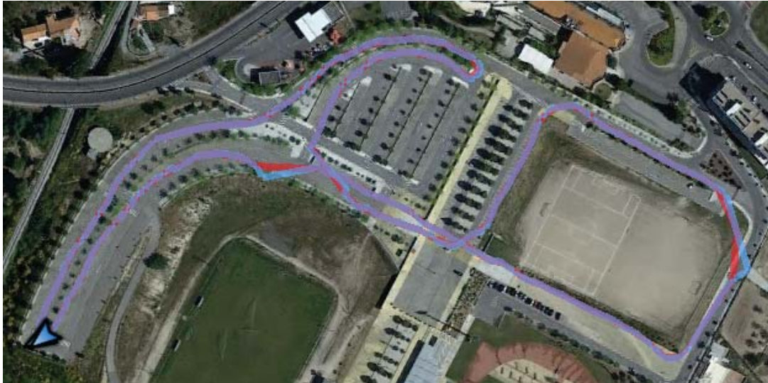
Figura B.58: Imagem dos trajectos recolhidos pelo Nexus 5. A azul o trajecto original e a vermelho o trajecto resultante da análise do algoritmo.
