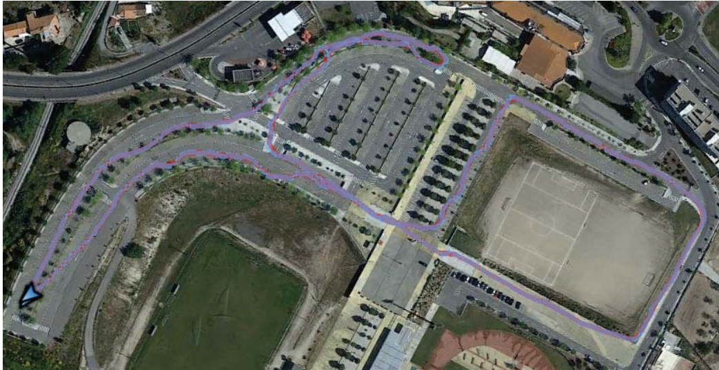
Figura B.8: Imagem dos trajectos recolhidos pelo LG G2. A azul o trajecto original e a vermelho o trajecto resultante da análise do algoritmo.
