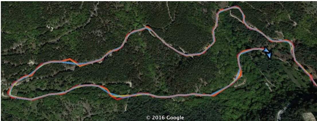
Figura A.8: Comapração entre três percursos. Imagem que mostra a totalidade do percurso realizado no Circuito de Manutenção da Covilhã. A azul o trajecto original recolhido pelo smartphone Wiko Wax, a vermelho o trajecto resultante do algoritmo elaborado e a amarelo o trajecto obtido pelo GPS Visualizer.
