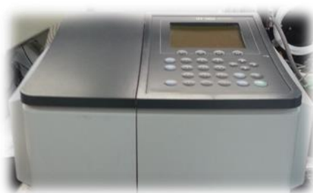
Figura 3. 4. Espectrofotômetro de absorção no UV-Visível de feixe duplo da Shimadzu, modelo UV-1800
