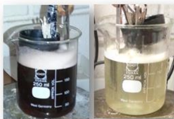
Figura 4.9. Diferença de cor entre as 0 e 12 horas de um ensaio eletroquímico a 70 \text{ mA cm}^{-2} , do efluente têxtil contendo corantes dispersos.
