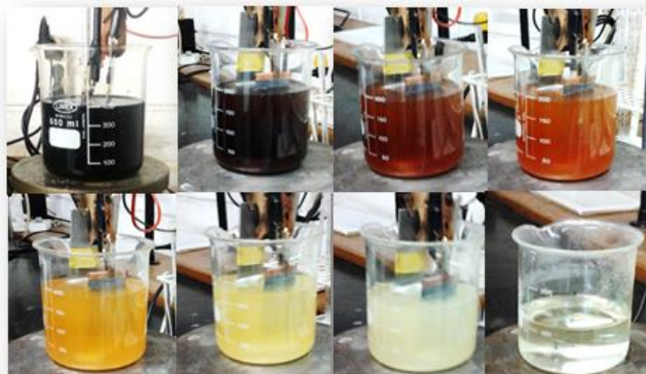
Figura 4.6. Variação de cor do ensaio eletroquímico a 40 \text{ mA cm}^{-2} do efluente têxtil de corantes reativos, com duração de 12 horas, tendo as amostras sido recolhidas às 0, 1, 2, 3, 4, 5, 6 e 12 h.
