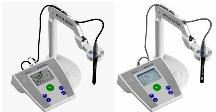
Figura 3.2. Equipamento utilizado no controlo de pH e de condutividade.
