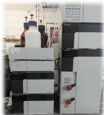
Figura 3. 5. Cromatógrafo de HPLC (Shimadzu), duas bombas modelo LC-20 AD, um forno para colunas CTO-20Ac e um detetor de condutividade modelo CCD-10 Avp
