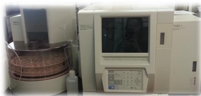
Figura 3. 3. Analisador TOC da Shimadzu, modelo TOC-V CSH
