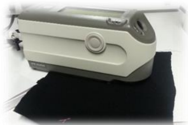
Figura 3.7. Espectrofotômetro Komica-Minolta Modelo CM-2600d
