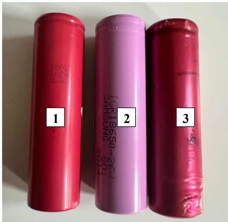
Figura 5-7: Baterias de íões de lítio do tipo cilíndrico utilizados nos ensaios experimentais (1- Bateria nova, 2- Bateria usada e 3- Bateria degradada).
