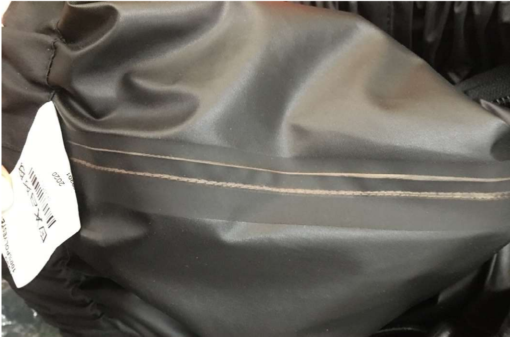
Figura 15- Costura impermeabilizada com fita termo colada.
