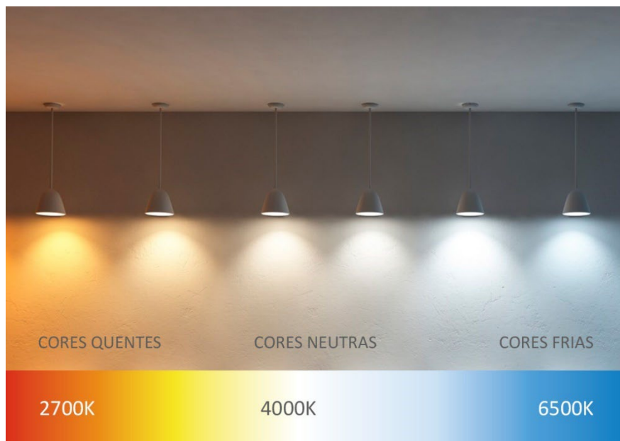
Figura 16. Representação do espectro das diversas temperaturas de cor, desde luzes com cores mais quentes até luzes com cores mais frias, retirado de (Design, 2019).
