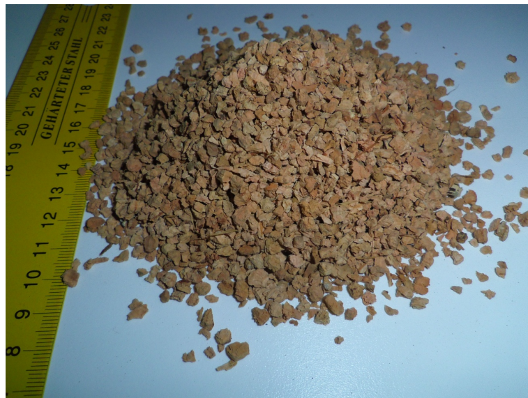
Figura 5.2.2. Granulado de cortiça com tamanho de partícula superior a 5 mm e uma densidade de 90 kg/m 3 .
