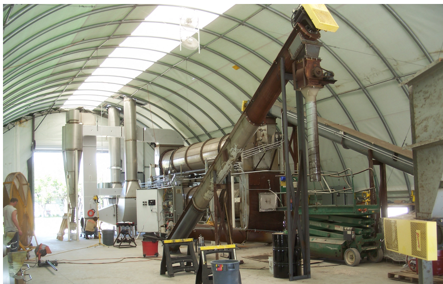
Figura 5.5.9. Reator de tipo rotativo pertencente à empresa Konza Renewable Fuels, dos EUA.
