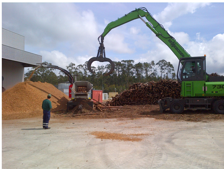
Figura 6.4.1. Equipamento de carga e descarga de madeira a operar num centro logístico de biomassa, no momento em que carrega um destroçador móvel de biomassa que produz estilha a partir de rolaria de pinheiro.
