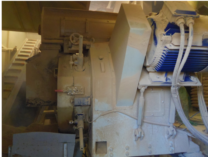
Figura 5.2.6. Pelletizadora Munch Edelshtal RMP 420 usada na produção dos pellets de cortiça.
