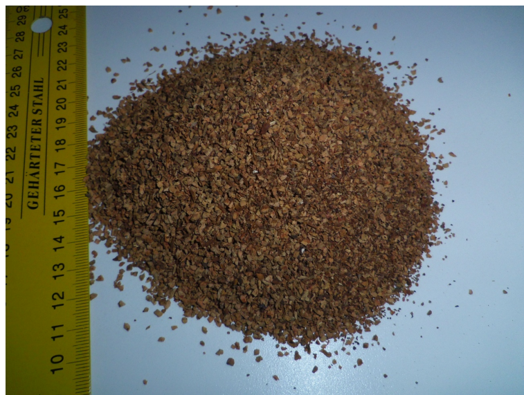
Figura 5.2.3. Granulado de cortiça com tamanho de partícula superior a 2 mm e uma densidade de 120 kg/m 3 .
