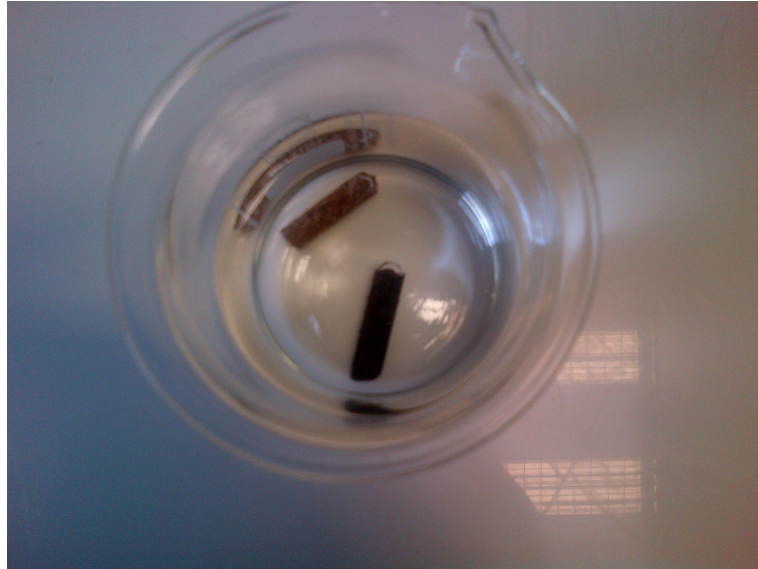
Figura 5.5.2.a. Ilustração da resistência à água do material torreficado e pelletizado , comparado com pellets de biomassa não tratada, após 5 minutos de imersão em água.
