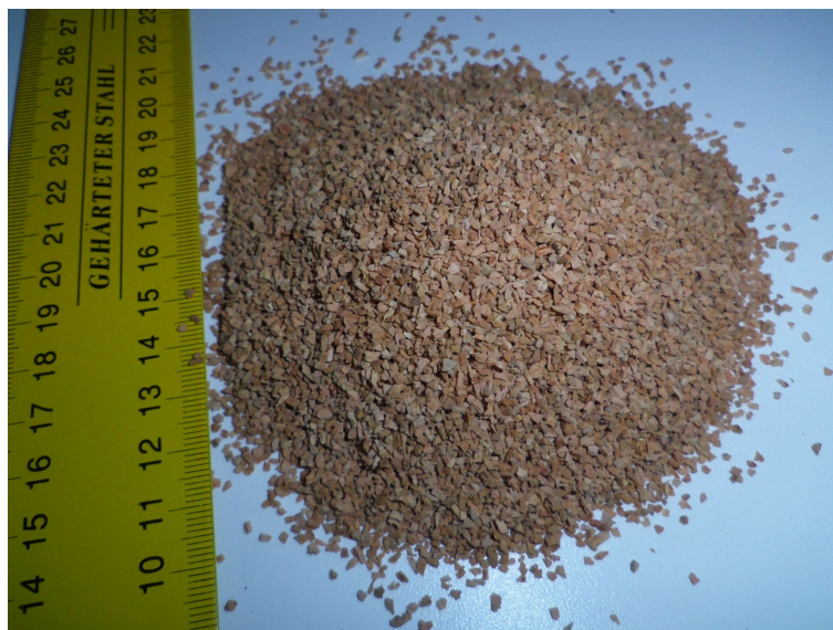
Figura 5.2.4. Granulado de cortiça com tamanho de partícula inferior a 2 mm e uma densidade de 60 kg/m 3 .
