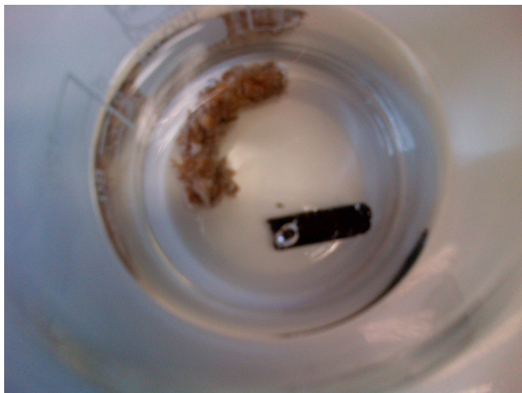
Figura 5.5.2.b. Ilustração da resistência à água do material torreficado e pelletizado , comparado com pellets de biomassa não tratada, após uma hora de imersão em água.
