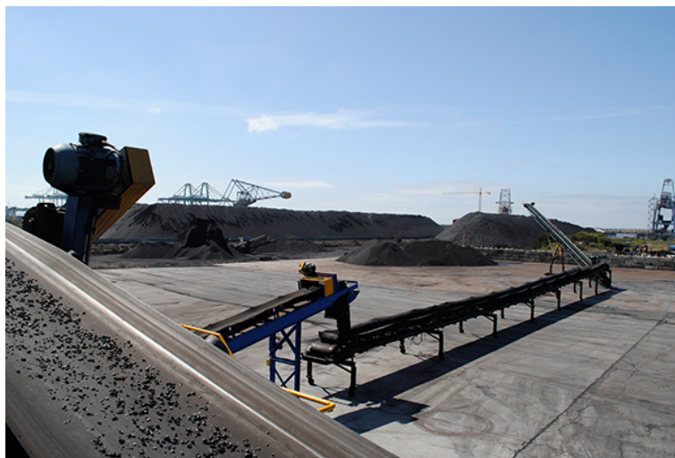
Figura 5.4.6. Carvão a ser transportado pelos tapetes transportadores para a unidade de moagem.
