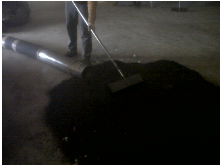
Figura 5.5.5. Introdução da amostra no processo industrial por transporte pneumático para ser submetida à moagem.
