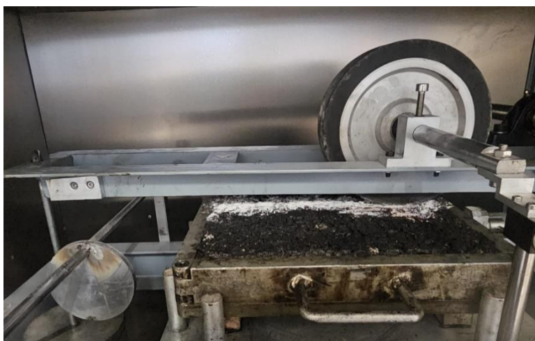
Figura 36 - Lajeta submetida ao ensaio de deformação permanente
