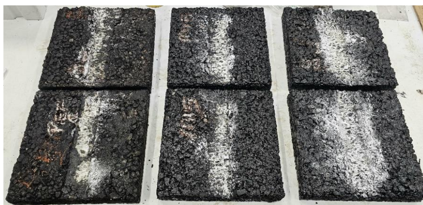
Figura 37 - Deformação permanente nas lajetas MR, M15 e M20
