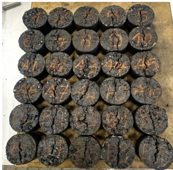
Figura 32 - Provetes ensaiados com falha tipo C
