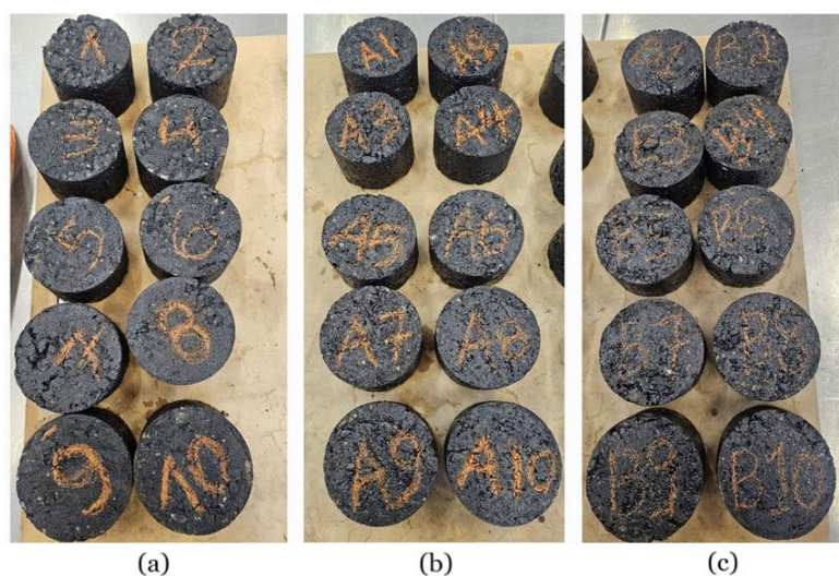
Figura 29 - Provetes cilíndricos para o ensaio de sensibilidade à água das misturas (a) MR, (b) M15 e (c) M20.
