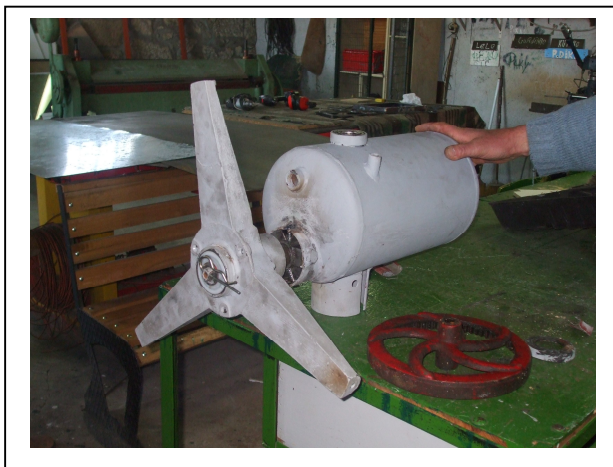
Construção de uma Eólica
