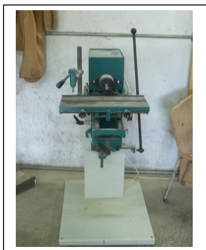
9 - Furadora por broca horizontal
