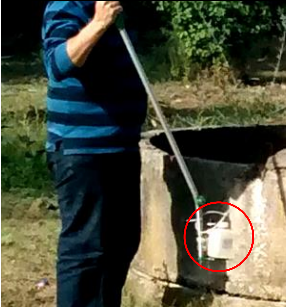
Figura 3.4 - Colheita das amostras efetuada através da submersão de frascos de polietileno esterilizados.
