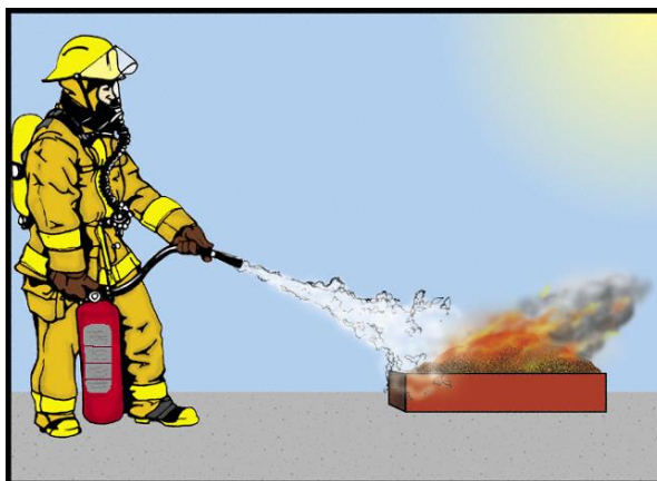
Figura 2.6 – Extinção de um incêndio por “inibição” [10]
