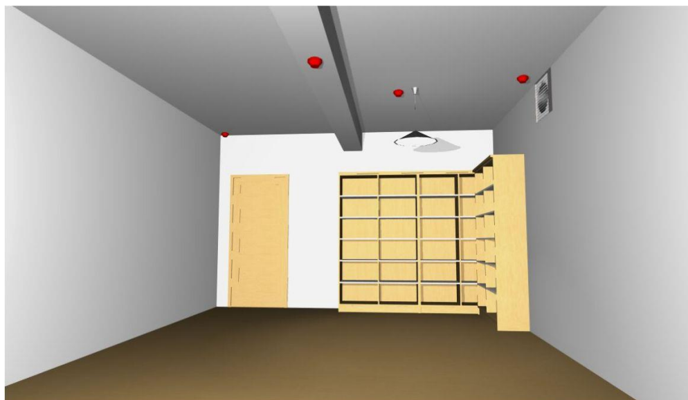
Figura 3.26 – Exemplos de localização errada dos detectores de incêndio.
