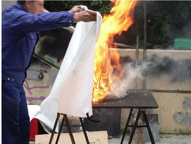
Figura 2.4 – Extinção de um incêndio por “asfixia/abafamento” [9]
