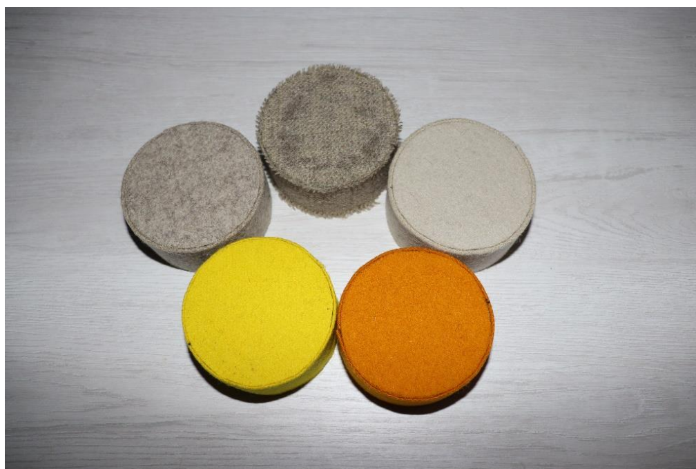
Figura 74: Amostras de discos de roofmate revestidos com Burel e Xerga (disco de cima) (Fonte: o autor)
