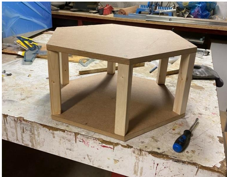
Figura 206: Montagem das tiras de pinho do puf sensorial (Fonte: o autor)
