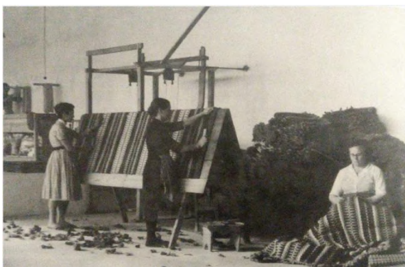
Figura 24 - Acabamento de Mantas na fábrica Perfil : escolha e embaçamento
