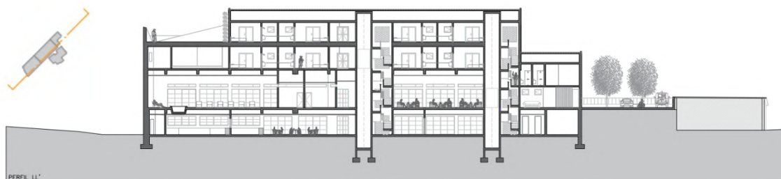
Figura 145 - Perfil longitudinal do volume residencial - acessos verticais.
