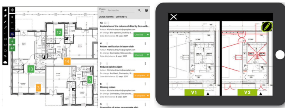
Figura 4.8: Exemplo de integração de ocorrências ou comentários nas plantas base do projeto (Lets Build, 2021).
