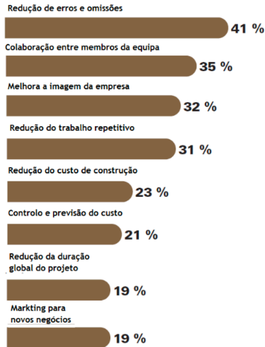
Figura 4.3 – Principais vantagens expectáveis da implementação do BIM para os empreiteiros nos primeiros três anos de integração (Fonte: McGraw Hill Construction, 2013).
