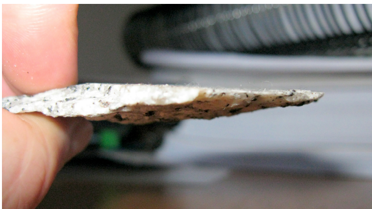
Figura 34: Lâmina de material recolhida após um ensaio em compressão excêntrica (espessura máxima \approx 6mm).
