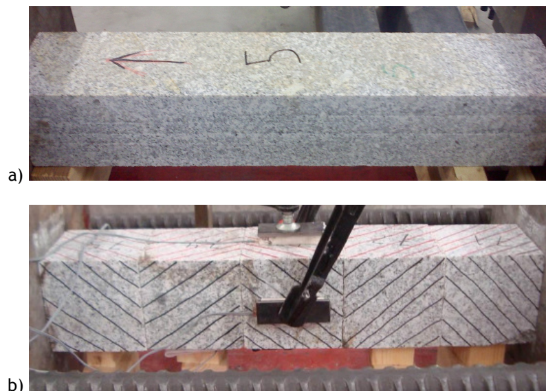
Figura 110: Provetes com relação h/b=6 ensaiados à compressão; a) Provete sem juntas; b) Provete com 4 juntas (adaptado de [5]).
