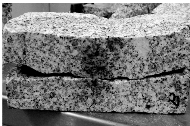
Figura 105: Imagem de um prisma de granito após rotura com perda de material na face e macrofratura.
