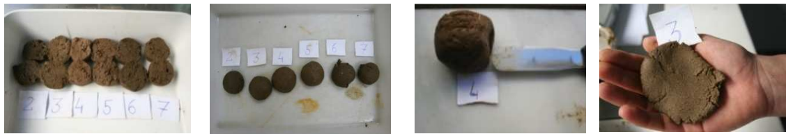
a) Ensaio do brilho b) Ensaio da queda de bola c) Ensaio da aderência, amostra C4 d) Ensaio da exsudação, amostra C3
