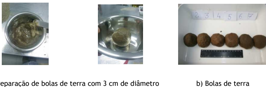
Figura 5.19 - Preparação de amostras para o ensaio do brilho, da queda de bola, da aderência e da exsudação
