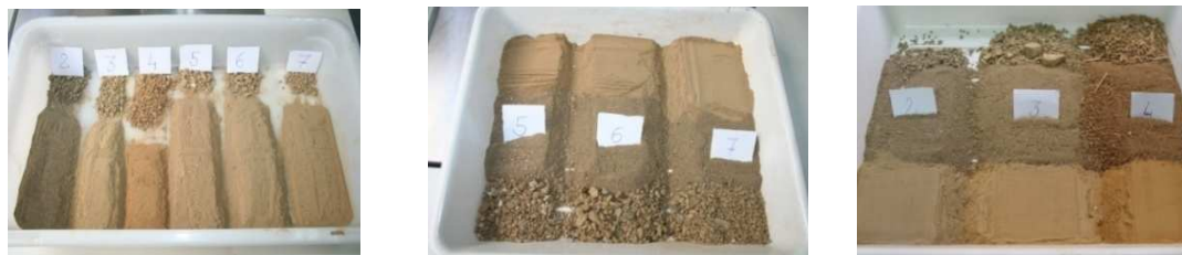
a) Ensaio de caracterização por tamanho das partículas
