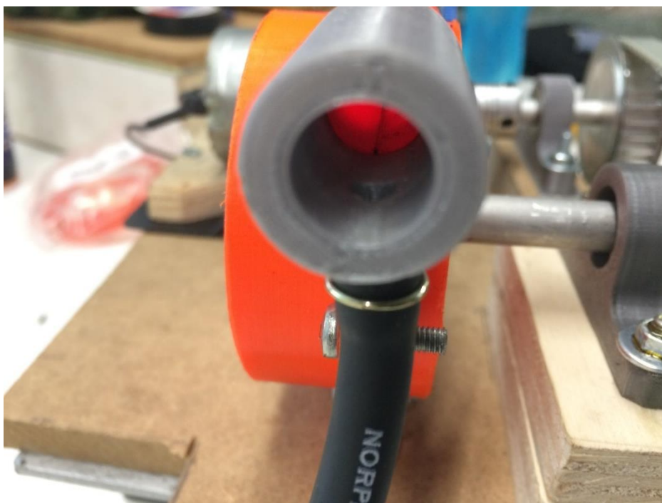
Figura M. 2 – Tomada de pressão estática em pormenor.
