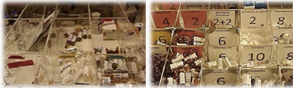
Figura 3 - Exemplo 5S: Gaveta de fármacos, antes (esquerda) e depois (direita) da aplicação dos 5S. Fonte: Matos, 2011
