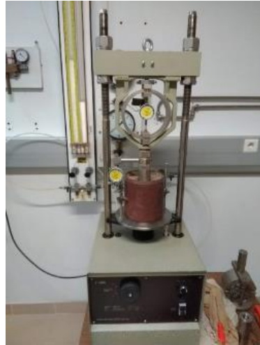
Figura A.I.1.1 – Equipamento utilizado para desenvolver os ensaios CBR
