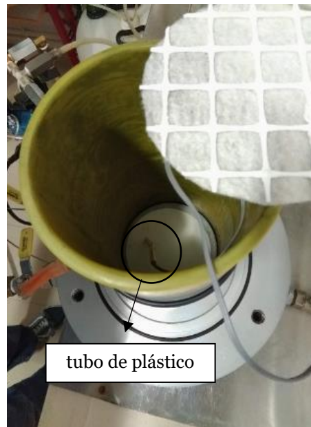
Figura 3.20 – Montagem para a preparação das amostras instrumentadas e sistema para medir extensões na geogrelha
