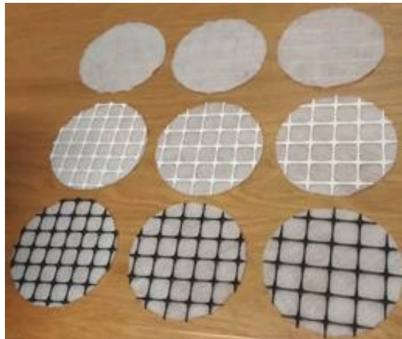
Figura 3.13 – Geocompósitos com diâmetro de 10 cm (ordem de cima para baixo: PP, PLA e RGD 8560)
