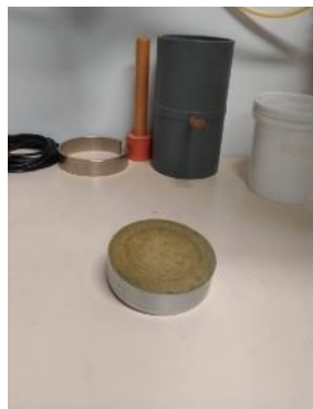
Figura 3.18 – Membrana de borracha com lubrificante utilizada no bloco de topo
