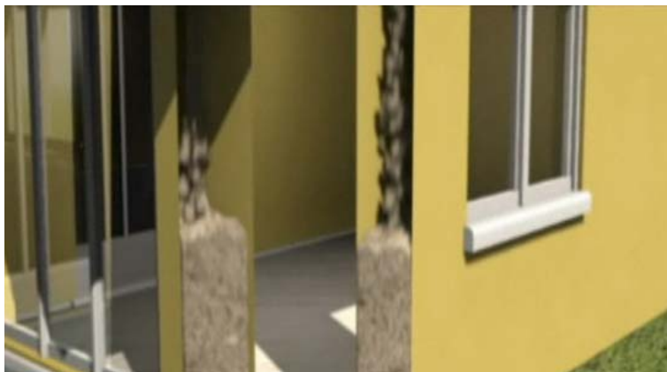
Figura 61 - Enchimento de paredes com isolamento à base de celulose [F59]
